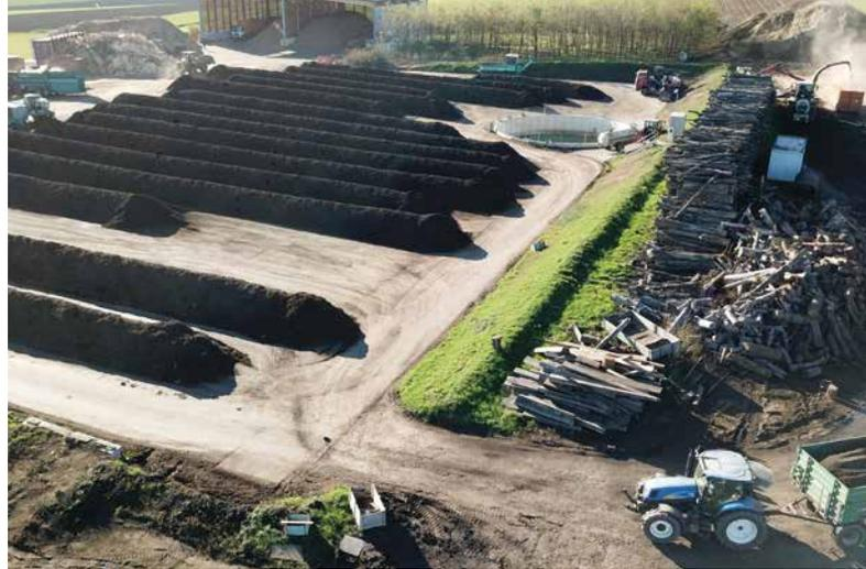
*händisches Absondern von Störstoffen, Bewässern, Temperaturmessung und Absieben. So entsteht jährlich auf unserer Anlage mithilfe von Wasser, Luft und Micro-Organismen aus etwa 35.000 m<sup>3</sup> Inputmaterial wertvoller Naturkompost, der für den biologischen Landbau geeignet ist.*
